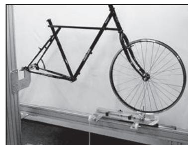
Utopia prüft während der Fertigung auf Spurgenaueigkeit und Seitensteifigkeit.
