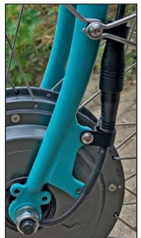
Motor mit Strom Kabel und Magnetstecker
