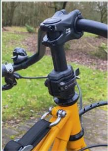
▶ Unten ist er 4 cm ausgefahren. Maximale Höhenverstellung sind 6 cm.
