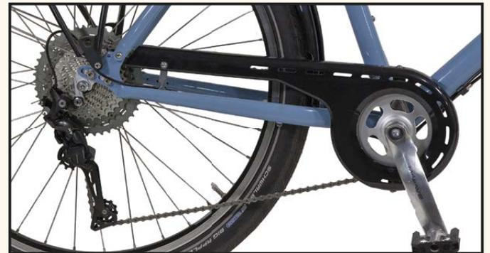
11-Gang Deore mit Standard Kettenschutz und Stahlkettenblatt.
