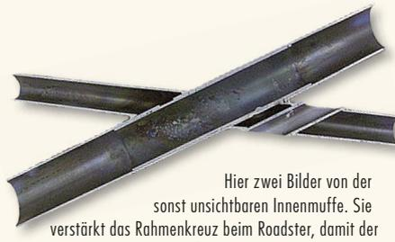
Hier zwei Bilder von der sonst unsichtbaren Innenmuffe. Sie verstärkt das Rahmenkreuz beim Roadster, damit der Rahmen auch bei sehr starker Überlastung (Aufprall oder Unfall) nicht im Kreuz wie ein „Einrohrahmen“ in zwei Teile brechen kann. Diese Muffe dient Ihrer Sicherheit.
