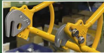
▶ Der Pedersen Rahmen mit Rohloff Ausfallende und zwei Rohrstege zur Rahmenverstärkung.
