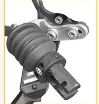
Die Weber ER Kupplung wird sicher in unserem Rohloff-Ausfallende befestigt, der Adapter wurde von Weber entwickelt.
