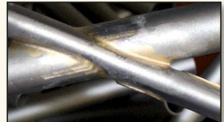
Das fertige Kreuz im Roadster, direkt nach der Lötung. Klar erkennbar, die beiden Rohre durchdringen sich in der Kreuzung. Die stabilisierende Innenmuffe ist nicht erkennbar.
