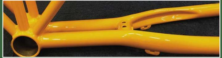
▶ Längerer Hinterbau mit Verstärkung der Seitensteifigkeit. Alle Rohre sind aus 24Cr/Mo4 Stahl.
