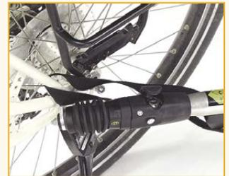
Die abschließbare Deichsel mit Fangleine passt optimal ans Rad. Sie belastet nicht die Hinterrad-Achse.
