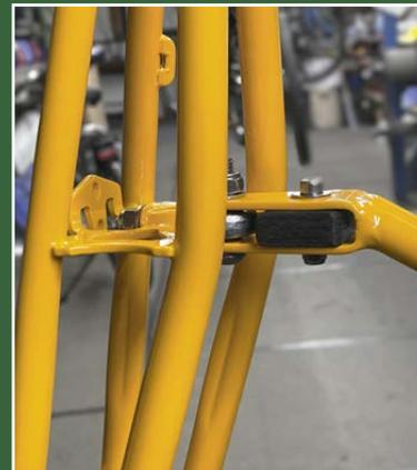
▶ Die Gabel mit im Rohr eingelassenen Kerben für beste Seitensteifigkeit.
