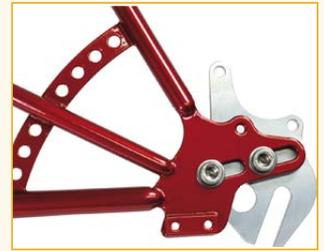
Alle Utopia Rahmen sind zur Aufnahme eines Hängers verstärkt mit einem Rohrsteig.
