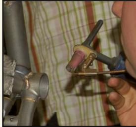
WIG-Löten bei einer Vorführung beim Utopia Sommerfest. Deutlich ist das Werkzeug zu sehen mit Schweißpunkt und daneben liegenden Kanalspitze zur Lötzuführen.
