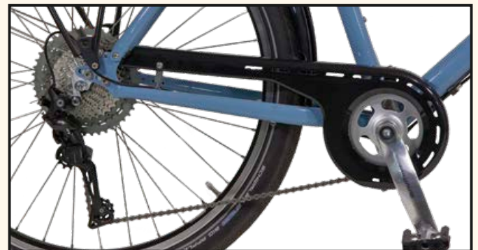
11-Gang Deore mit Standard Kettenschutz und Stahlkettenblatt.
