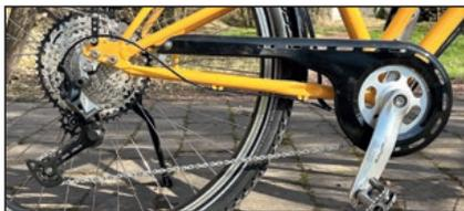
Diese Schaltung für Trekkingbikes überzeugt durch geringes Gewicht, leichte Bedienbarkeit, eine sehr gute bergtaugliche Übersetzung und leichtes Schalten. Damit ist sie für Reisen und Alltag gut geeignet. Man freut sich, dass es hier keinen empfindlichen Umwerfer vorne gibt. Die Gänge lassen sich mit dem SLX Schaltgriff leicht bedienen und Sie finden sofort wie bei Nabenschaltung den passenden Gang.
