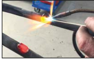
► Klassisches Löten für die Kabellösungen.
