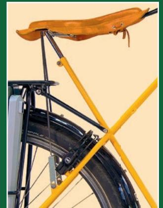
Der Gepäckträger wird mit zwei Streben am Mittelrohr befestigt.
