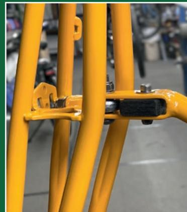
Die Gabel aus 25CrMo4 Rohr mit eingelassenen Kerben für beste Seitensteifigkeit.
