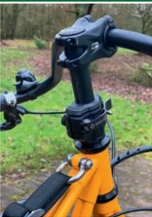
Unten ist er 4 cm ausgefahren. Maximale Höhenverstellung sind 6 cm bei Rahmenhöhe M. Bei L und XL bis 10cm.
