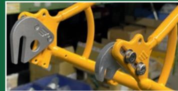
Der Pedersen Rahmen mit Rohloff Ausfallende und zwei Rohrstegegen zur Rahmenverstärkung.
