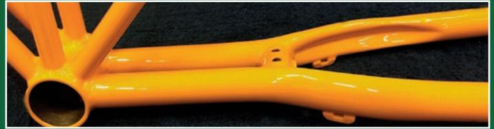
Längerer Hinterbau mit Verstärkung der Seitensteifigkeit. Alle Rohre sind aus 25CrMo4 Stahl.
