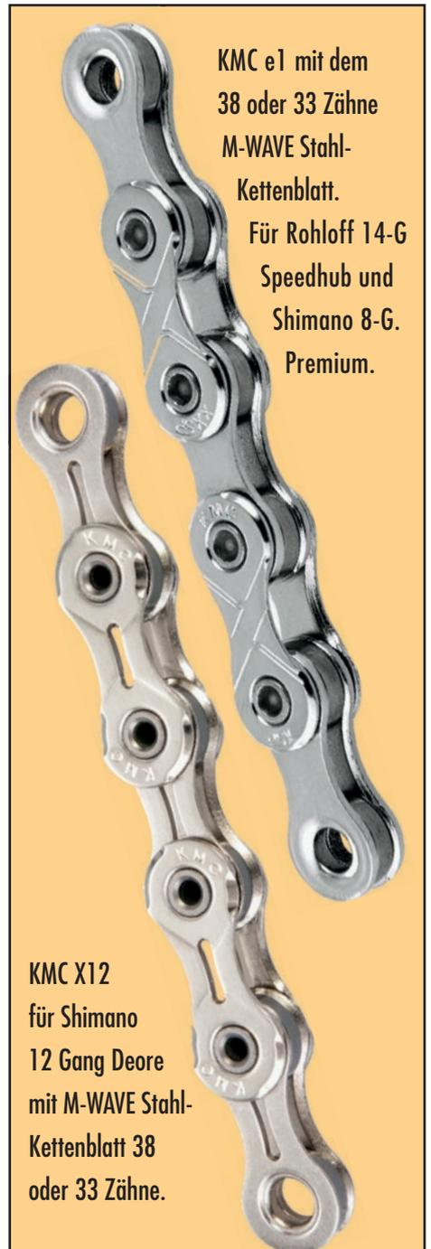
KMC e1 mit dem 38 oder 33 Zähne M-WAVE Stahl-Kettenblatt. Für Rohloff 14-G Speedhub und Shimano 8-G Premium.
