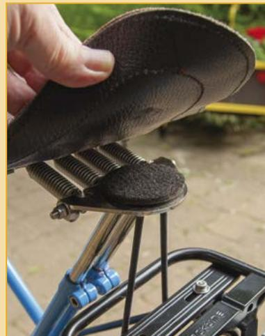
Von der Sattelstütze ausgehend sind unter dem Sattel 4 Federelemente, die den Sattel optimal dem Benutzer anpassen und das Fahren auf unebenen Strecken angenehm machen. Die aufgeklebten Filz pads auf der Sattelstütze erhöhen den Fahrkomfort und schonen Fahrer und Leder. Ab sofort sind sie an allen Pedersen Rädern.
