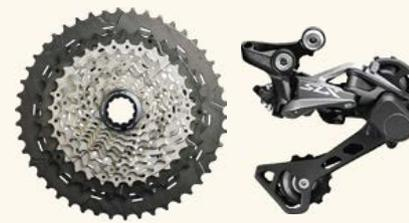
Die Schaltung für Trekkingbikes überzeugt durch geringes Gewicht, leichte Bedienbarkeit, eine sehr gute bergtaugliche Übersetzung und leichtes Schalten. Damit ist sie für Reisen und Alltag gut geeignet. Man freut sich, dass es hier keinen empfindlichen Umwerfer gibt. Schaltwerk und Griff können optional auch als XT gewählt werden. Der XT Schalter ist für MTB Einsatz ausgelegt und benötigt mehr Kraft.
