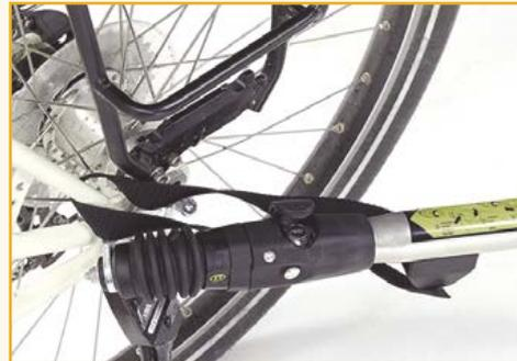
Die abschließbare Deichsel mit Fangleine passt optimal ans Rad. Sie belastet nicht die Hinterrad-Achse.
