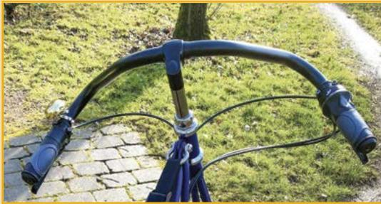
Der NEUE ROYAL Lenker für Pedersen ist aus MAS (Micro Alloy Steel) wie alle Utopia Lenker: Haltbar, bruchstabil und schwarz pulverbeschichtet. Diese Lenker sind viel leichter als Stahllenkern und kaum schwerer als Aluminium. Mit Umweltschutz und CO<sub>2</sub> ist die Zeit der Verchromung vorbei.
