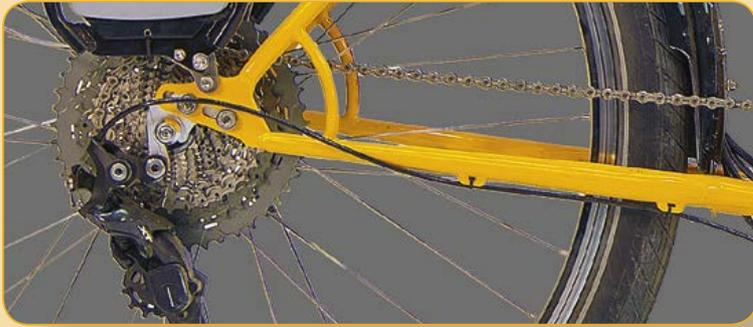
Die neuen Pedersen Rahmen haben das Original Rohloff Ausfallende. Dazu kommt ein Rohrsteig zur Hinterbauverstärkung.
