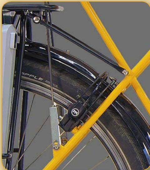
Der Gepäckträger wird jetzt an den Sattelrohren mit zwei Alu-Streben und kräftigen M6 Schrauben in neuen Anlötteilen befestigt und die Gewindestangen werden in den neuen Anlötteilen befestigt, nicht am Ausfallende. Sie behindern nicht mehr die Gepäckträger-Montage und die Belastung vom Sattel wird direkt am Hinterbau aufgenommen.
