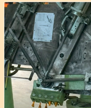
Hydraulische Rahmenbau Vorrichtung bei Rainbow.
