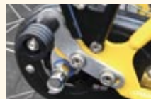
Monoporter CR-Kupplung am Rohloff Ausfallende.
