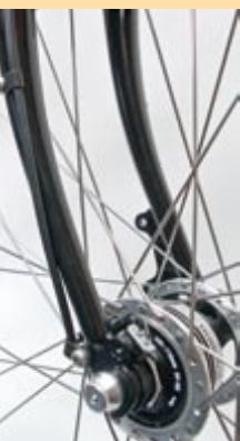
Lichtkabelführung am Bremssockel und an der Low Rider Oese.
