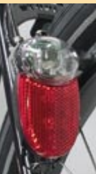
Rücklicht am Bremssockel, wenn kein Gepäckträger gewünscht wird.
