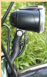
Kurzer Niro-Lampenhalter, wird montiert, wenn das Rad KEINE Schutzbleche hat.
