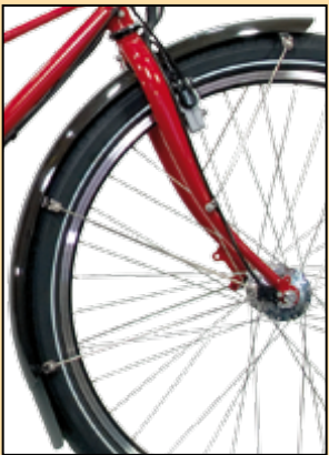
Vorne mit Spritzschutz und Zusatzstrebe.
