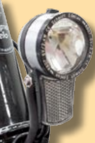
Kurzer Niro-Lampenhalter, wird montiert, wenn das Rad KEINE Schutzbleche hat.
