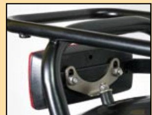
Die Schutzblech-Befestigung am Gepäckträger ersetzt die Strebe (die sonst am Träger scheuert) und hält das Schutzblech auch auf unebenen Wegen vibrationsfrei..
