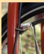
Lichtkabelführung am Bremssockel und an der Low Rider Oese.
