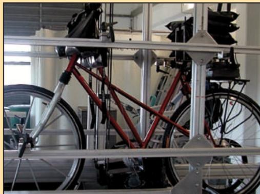
Kranich mit voller Beladung auf dem Trommelprüfstand. In der Realität sollte man solch brutale Stöße vermeiden und das Rad beim Überfahren von Holperstrecken entlasten.
