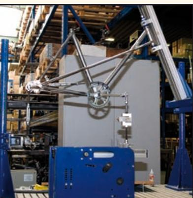
Rahmenprüfmaschine in der Produktion.
