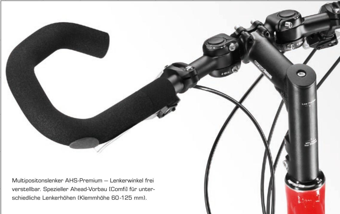
Multipositionslenker AHS-Premium – Lenkerwinkel frei verstellbar. Spezieller Ahead-Vorbau (Comfi) für unterschiedliche Lenkerhöhen (Klemmhöhe 60-125 mm).
