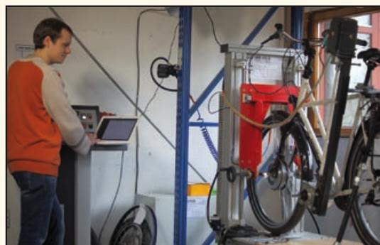
Wir haben seit Dezember 2011 den ersten selbständig laufenden Prüfstand für Fahrräder, auf dem jedes Elektrorad getestet wird. Damit sind wir im Fahrradbau auf einem Standard, der bisher nur im Motorrad- und Autobereich üblich war, nicht aber in der Fahrradproduktion.
