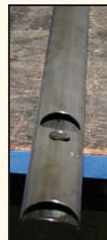
Trinkflaschenösen, Rohrkreuzungen und die konkave Rohrverbindungsstelle müssen ganz exakt gefräst werden.
