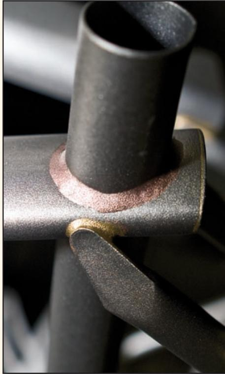
SilberMöwe Rahmen nach dem Sandstrahlen. Alle Lötverbindungen sind jetzt gut sichtbar. Die verschiedenen Verfahren sind an der Farbe erkennbar. Die kleinen Lötstellen an der Hinterbaustrebe und am Ende des Ovalrohrs werden klassisch gelötet. Das Sattelrohr muss von oben und unten komplett im WIG-Lötverfahren gesichert werden, denn hier durchdringt es das ovale Oberrohr.
