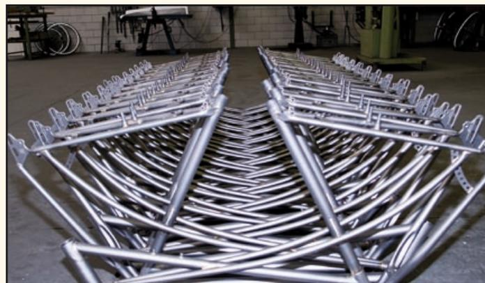
Möwe Rahmenlager. Gestrahlt, phosphatiert und beschichtet wird erst, wenn der Auftrag kommt.
