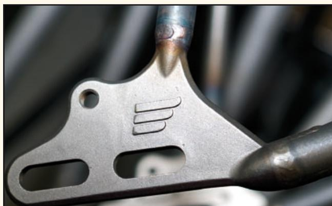
Das Nirossta Utopia Ausfallende wird durch TIG Schweißen mit den CroMo Rohr verbunden.
