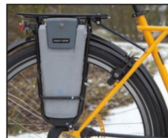
Der wasserdichte Batteriebehälter kann von der Steuerungseinheit getrennt und abgenommen werden, ohne dass Sie einen Stecker ziehen müssen. Er ist mit Schloss gesichert. Das dient dem Diebstahlschutz wie auch der sicheren Befestigung am Rad.
