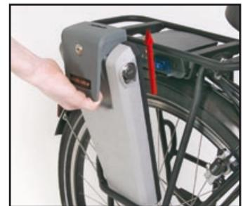
Drei Arbeitsschritte zur Herausnahme des Akkus: Aufschließen, Klappe leicht liften und dabei Akku leicht schräg stellen, nach oben weg ziehen. Das Einsetzen geht in umgekehrter Reihenfolge.
