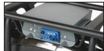
Um bei Fahrten ohne Akku die Kontakte nicht zu verschmutzen, einfach eine der beiden Abdeckungen aufstecken.
