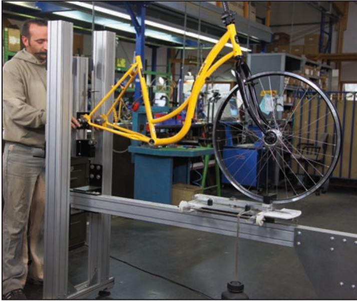
Zu Beginn der Montage wird der Rahmen mit einem normierten Vorderrad in diesen Prüfstand gestellt.
