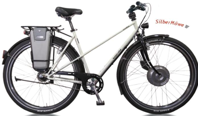
Rahmenhöhe 54 mit Elektroantrieb, 28" (622mm)
