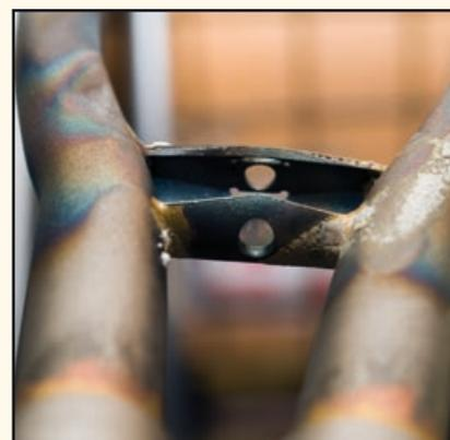
Der warmverformte Hinterbau mit offenem Rohrsteig.
