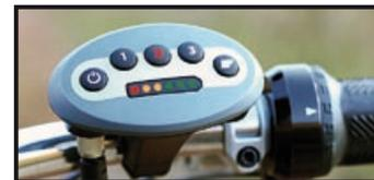
Cockpit am Lenker: Über das wasserdichte Display werden alle Funktionen gesteuert. Links die Starttaste, in der Mitte die Motorstufen 1,2,3. Rechts die Starthilfe und unten die Akkustand-Anzeige. Einfach zu bedienen, auch im Dunkeln oder mit Handschuhen.
