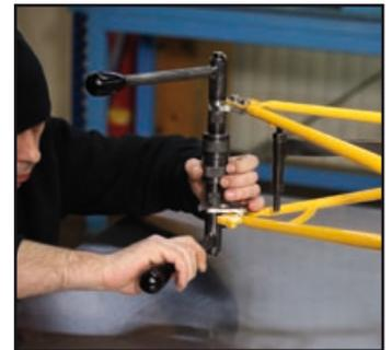
Jeder Rahmen wird in Holland vorgerichtet. Bei Utopia kommt dann die Feinarbeit: Hier wird exakt auf wenige Zehntel Toleranz genau ausgerichtet. Diese Genauigkeit verlangt Geduld und das richtige Gefühl in der Hand. Die Anlage ist eine Sonderanfertigung für die langen Utopia Rahmen.
