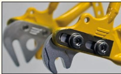
Die Schraubbefestigung muss nicht fest angezogen werden, denn die schienengleiche Grundsicherung verhindert, dass das Hinterrad sich schräg stellen und am Hinterbau schleifen kann. Manche Nachbauten der Rohloff Ausfallende verzichten aus Kostengründen auf diese aufwendige CNC Fräsung. Für das hohe Drehmoment in den Berggängen reicht es dann nicht aus, das Hinterrad stellt sich schräg.
