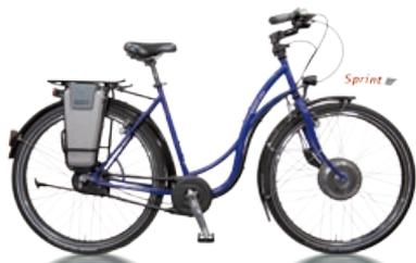
Rahmenhöhe 54 mit Elektroantrieb, 28" (622mm)
