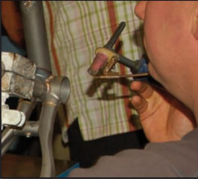
WIG-Löten bei einer Vorführung beim Utopia Sommerfest. Deutlich ist das Werkzeug zu sehen mit Schweißpunkt und daneben liegenden Kanalspitze zur Lötzuführen. Es braucht eine besonders ruhige Hand um diese Arbeit an einem Rundrohr ohne Abzusetzen durchzuführen.
