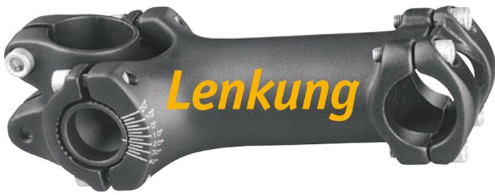
**Der Lenker wird in der Regel sehr bewusst gewählt, da man ihn beim Fahren ständig in der Hand hält. Der Vorbau und die Lenkerhöhenverstellung bleiben dagegen oft unbeachtet. Dabei bieten sie erst die Möglichkeit, den Lenker in der richtigen Neigung, Höhe und Entfernung zum Körper einzustellen. Deshalb beginnen wir damit.**
