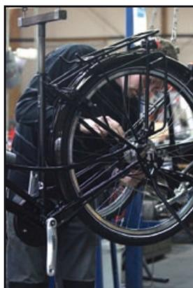
Der wichtigste Bereich ist die Montage. Alle Modelle werden hier in vier Stationen aufgebaut. Bei jeder Station sind alle Bauteile gelagert, die zu diesem Bereich gehören.
