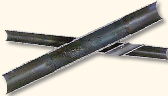
Hier zwei Bilder von der sonst unsichtbaren Innenmuffe. Sie verstärkt das Rahmenkreuz beim Roadster, damit der Rahmen auch bei sehr starker Überlastung (Aufprall oder Unfall) nicht im Kreuz wie ein „Einrohrahmen“ in zwei Teile brechen kann. Diese Muffe dient Ihrer Sicherheit.
