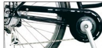
Robuster Kettenschutz aus Kunststoff, der zu jeder Schaltung und Übersetzung und an jedes Utopia Modell außer an den Phoenix passt. Damit werden Kettenblatt und die Kette oben gut abgedeckt.
