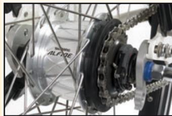
Die 8-Gang Alfine ist das bewährte Spitzenprodukt von Shimano bei Nabenschaltung. Bessere Lager und Getriebe erhöhen spürbar den Wirkungsgrad.
