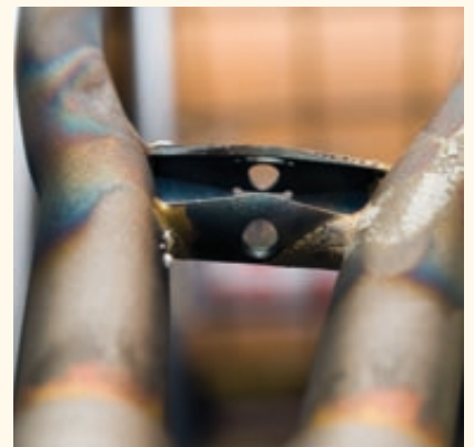
Der warmverformte Hinterbau mit offenem Rohrsteig.
