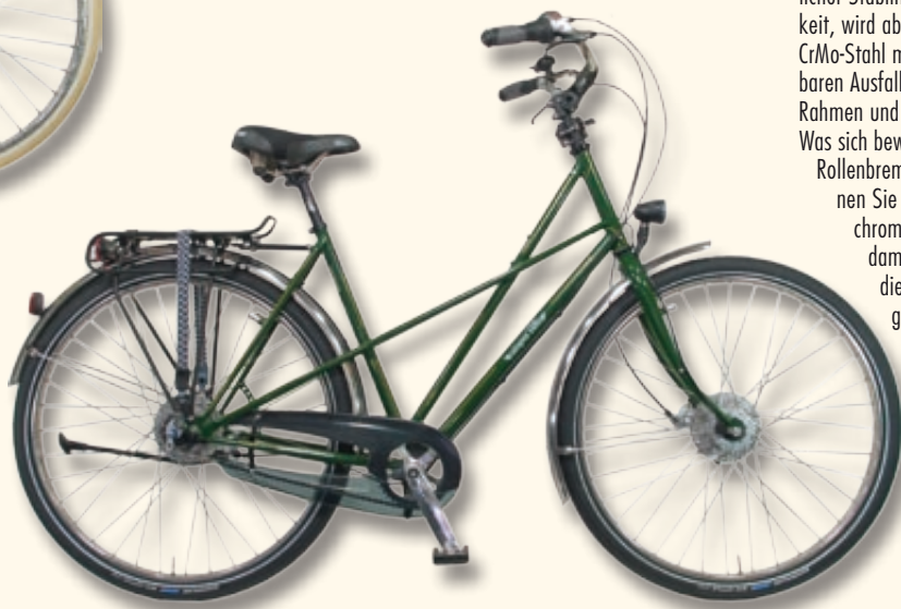
Utopia Kranich 2009, Rahmenhöhe 54cm, 8- Gang Premium, Rollenbremsen, Westwood Nirofelgen, Niro-Schutzblech und Cruiser Niro-Lenker.
