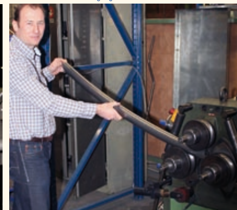
So kommt die Biegung ins Libelle Rohr.
