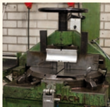
Diese Maschine stellt die „Spiegelung“ her, mit der die Hinterbaustrebe oben am Sattelrohr angelötet wird.
