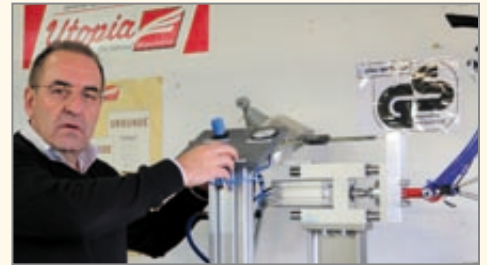
Die Prüfvorrichtung für den Belastungstest von Rahmen und Gabel wurde vom Fahrradsachverständigen Ernst Brust (Velotech.de) konstruiert.
