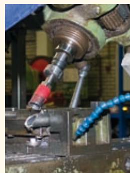
Diese Maschine stellt die „Spiegelung“ her, mit der die Hinterbaustrebe oben am Sattelrohr angelötet wird.
