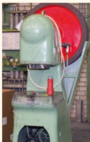
Diese Maschine stellt die „Spiegelung“ her, mit der die Hinterbaustrebe oben am Sattelrohr angelötet wird.
