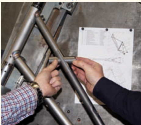
Die Kreuzmuffe des London wird eingepasst.
