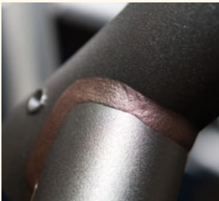
Die breite Befestigungsspur der WIG Lötung.
