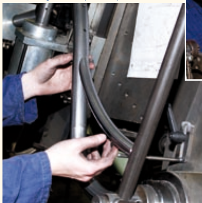
Das Durchstiegsrohr des Sprint wird justiert.
