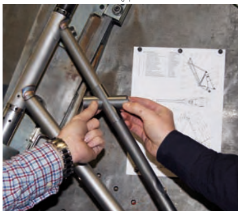
Die Kreuzmuffe des London wird eingepasst.
