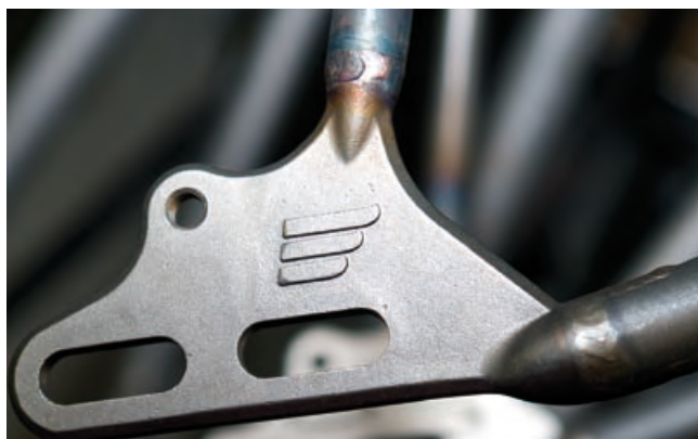
Das Nirosta Utopia Ausfallende wird durch TIG Schweißen mit den CrMo Rohr verbunden.
