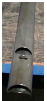
Trinkflaschenösen, Rohrkreuzungen und die konkave Rohrverbindungsstelle müssen ganz exakt gefräst werden.
