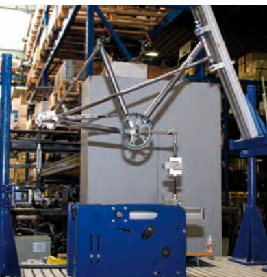
Rahmenprüfmaschine in der Produktion.
