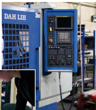
Die Rohre werden nach Zuschnitt in der CNC-Fräse bearbeitet.
