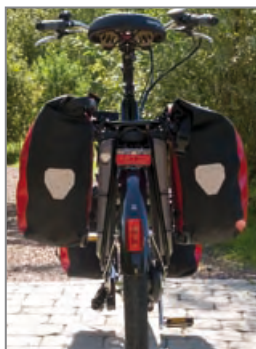
Von hinten sind die Akkus kaum zu erkennen. Mit Packtaschen sieht man nicht, dass hier ein Rad mit Elektromotor fährt.
