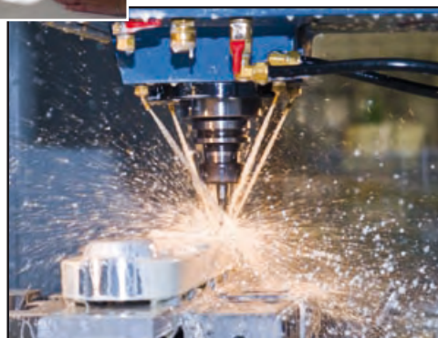
Die Rohre werden nach Zuschnitt in der CNC-Fräse bearbeitet.
