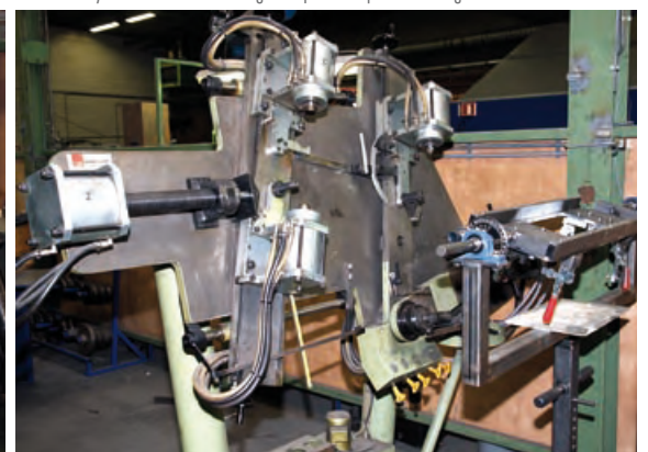
In dieser hydraulischen Vorrichtung wird jeder Utopia Rahmen geboren.
