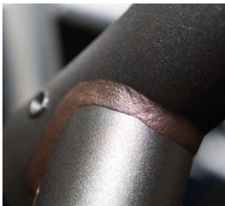
Die breite Befestigungsspur der WIG Lötung.
