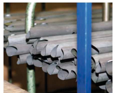
Trinkflaschenösen, Rohrkreuzungen und die konkave Rohrverbindungsstelle müssen ganz exakt gefräst werden.
