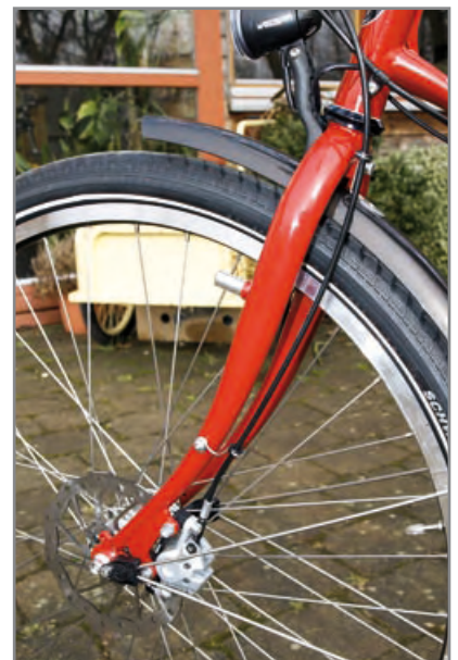
Für Rollenbremse (Bild oben) und Scheibenbremse (Bild unten) hat Utopia eine solide Kabelverlegung mit Drahtschlaufen und Gummiführung, ähnlich wie beim Motorrad, entwickelt.
