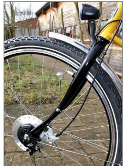
Für Rollenbremse (Bild oben) und Scheibenbremse (Bild unten) hat Utopia eine solide Kabelverlegung mit Drahtschlaufen und Gummiführung, ähnlich wie beim Motorrad, entwickelt.
