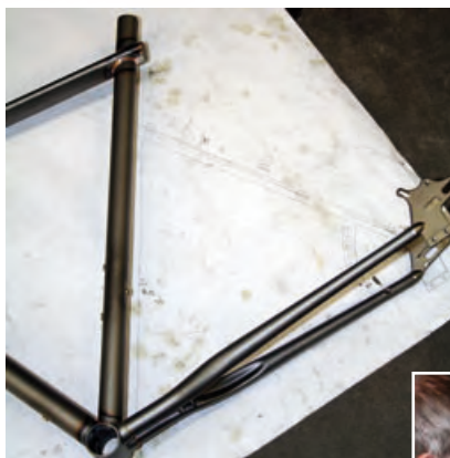
Kontrolle in der Fertigung mit 1:1 Ausdruck
