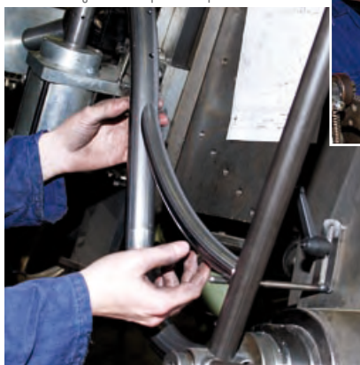
Das Durchstiegsrohr des Sprint wird justiert.
