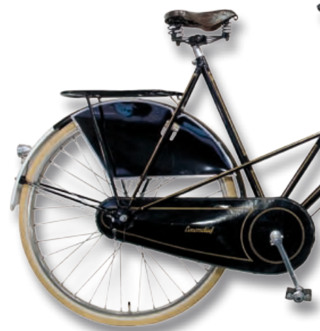
Locomotief Super de Luxe von 1950, Rahmenhöhe 62cm, Sturmey-Archer 3 Gang und Trommelbremsen, Niro Westwood Felgen und Holland Tourenlenker.
