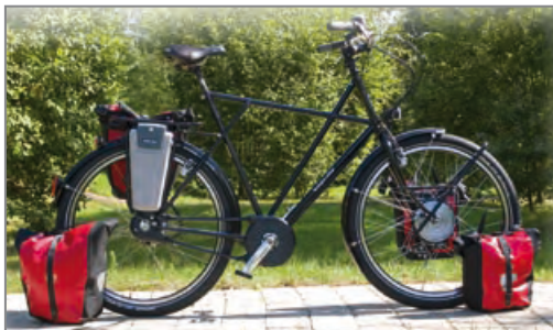
Die schmalen Batteriebehälter machen es möglich: Sie können Ihre (Ortlieb) Taschen wie gewohnt am Tubus Träger einhängen.
