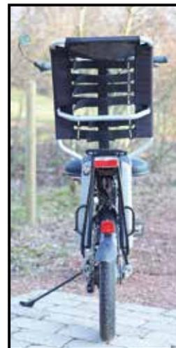
Phoenix mit Silent-Antrieb. Die schmalen Akkus sind elegant im Träger integriert.
