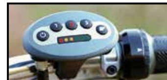
Cockpit am Lenker: Über das wasserdichte Display werden alle Funktionen gesteuert. Links die Starttaste, in der Mitte die Motorstufen 1,2,3. Rechts die Starthilfe und unten die Akkustandsanzeige. Einfach zu bedienen, auch im Dunkeln oder mit Handschuhen.
