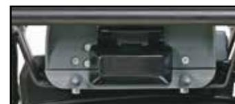
Um bei Fahrten ohne Akku die Kontakte nicht zu verschmutzen, einfach eine der beiden Abdeckungen aufstecken.
