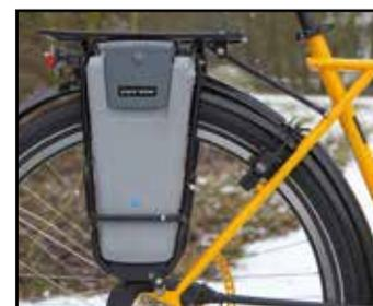
Der wasserdichte Batteriebehälter kann von der Steuerungseinheit getrennt und abgenommen werden, ohne dass Sie einen Stecker ziehen müssen. Er ist mit Schloss gesichert. Das dient der sicheren Befestigung am Rad. So kann der Akku nicht rausfallen.
