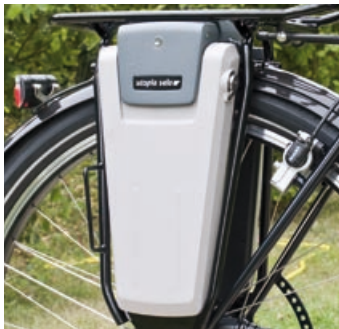
Der wasserdichte Batteriebehälter kann von der Steuerungseinheit getrennt und abgenommen werden, ohne dass Sie einen Stecker ziehen müssen. Er ist mit Schloss gesichert. Das dient dem Diebstahlschutz wie auch der sicheren Befestigung am Rad.
