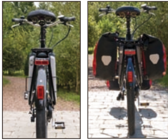
Die schmalen Batteriebehälter machen es möglich: Sie können Ihre (Ortlieb) Taschen wie gewohnt am Tubus Träger einhängen.
