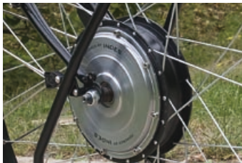
Der Frontmotor von Indes aus Holland läuft ganz leise, denn er hat kein Getriebe. Das garantiert lange Lebensdauer.
