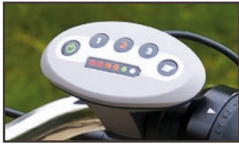
Cockpit am Lenker: Über das wasserdichte Lenkerdisplay werden alle Funktionen gesteuert: Links ist das grüne Startfeld, daneben die Einstellung der Unterstützung von 1-3 und rechts die Taste für die Starthilfe unter 6km/h.
