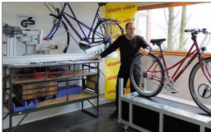
Ein Bild aus Mitte Januar: Die Prüfvorrichtung für den Belastungstest von Rahmen und Gabel (oben links im Bild) wurde mit Hilfe von Ernst Brust (Bildmitte) gerade aufgebaut und eingerichtet. Rechts steht der Prototyp einer Anlage zur Funktionsprüfung des fertigen Pedelec. Der erste Test ist schon erfolgreich verlaufen.
