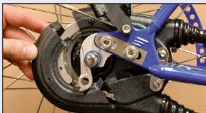
Das hintere Countryteil behutsam herausnehmen, danach ist die Achse frei zum herausnehmen. Sie sehen dabei die Niro-Befestigung des Country.
