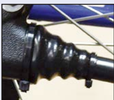
Das PE-Rohr für die Kettenführung muß an den Enden aufgebogen sein.
