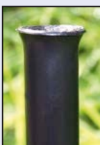
Das PE-Rohr für die Kettenführung muß an den Enden aufgebogen sein.
