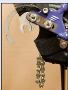
Das hintere Countryteil behutsam herausnehmen, danach ist die Achse frei zum herausnehmen. Sie sehen dabei die Niro-Befestigung des Country.
