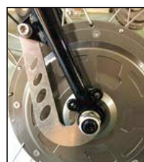
Frontmotor mit Drehmomentstütze und Anlötteil an der Gabel.
